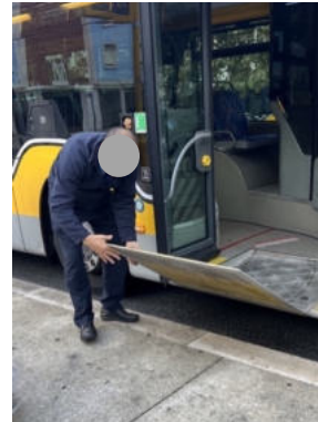
Imagem 7 – Carris. Instalação da rampa manual.
