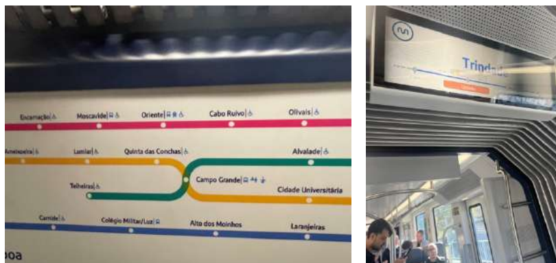
Imagens 97 e 98 – Lisboa e Porto. O diagrama na carruagens do metro em Lisboa assinala as estações acessíveis, mas sem suficiente legibilidade, dada a altura a que é colocado e a falta de ampliação do respetivo símbolo.
