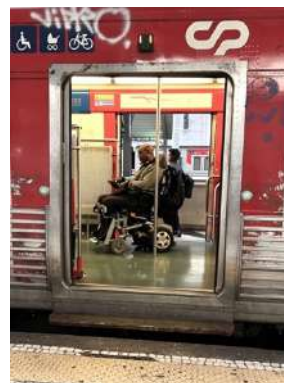
Imagem 5 – Desalinhamento entre o cais de embarque e a entrada do comboio.
