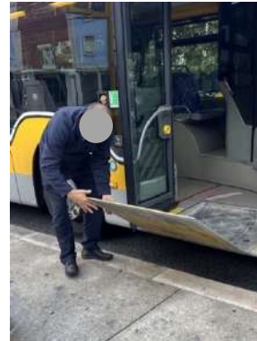
Imagem 7 – Carris. Instalação da rampa manual.
